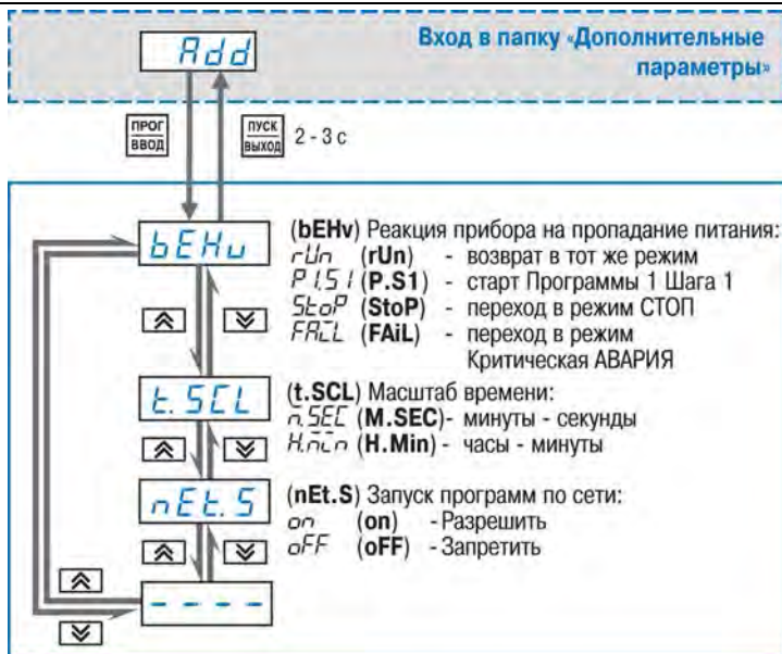
Рисунок 7.9 - Схема задания дополнительных параметров прибора
